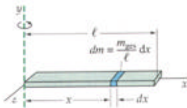
8.9 Zur Berechnung des Trägheitsmomentes eines homogenen Quaders mittels Integration. Die Drehachse steht senkrecht zum Quader und geht durch eines seiner Enden.
