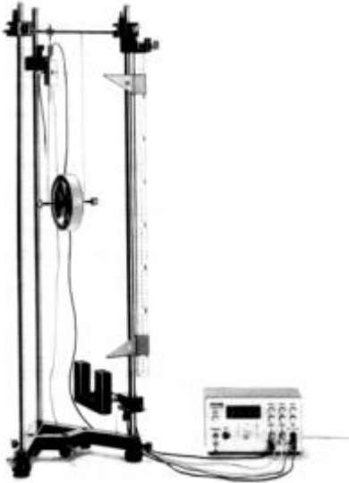
Fig. 1: Experimenteller Aufbau zur Untersuchung der Energieerhaltung am Maxwellschen Rad.
